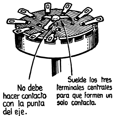
Fig. 6 - El Conmutador visto por la parte de los terminales.
